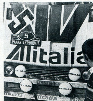
Per paura dei sassi, sopra, le 131 adottavano questi coprifari. Sotto, uno degli ammortizzatori adattati (essendo del tipo più vecchio non ad alto scuotimento) ai nuovi attacchi sulle vetture che vogliono ammortizzatori più lunghi
